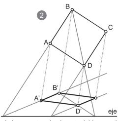
1º- Trazamos la dirección de afinidad AA', prolongamos el segmento AB hasta el eje encontrando el punto doble a partir del cual pasamos una recta por A'. Pasando por B la dirección de afinidad AA' encontramos sobre la recta homóloga el punto B'.
