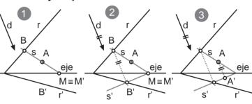
Hallar el triangulo a'b'c' afín al triángulo ABC dado. Datos: triángulo ABC, punto B' Afín a B y eje de afinidad
