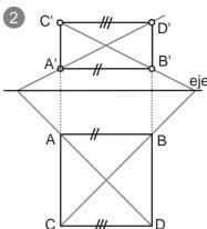
A partir de A' Y D' trazamos paralelas aAB y CD (paralelas al eje de afinidad)
