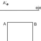
1º- Trazamos la diagonal AD hasta cortar el eje y desde el punto doble pasamos una recta por A' que será su afín. Trazando la direccion AA' por B y D. encontramos sobre la diagonal Afín el punto D'.
