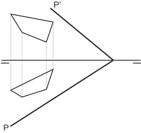
b) Dada la traza horizontal del plano  $P$  y su otra traza abatida ( $P$ ) sobre  $PH$ , también un triángulo contenido en el plano en verdadera magnitud y forma. Representa la traza vertical del plano y las proyecciones vertical y horizontal del triángulo.
