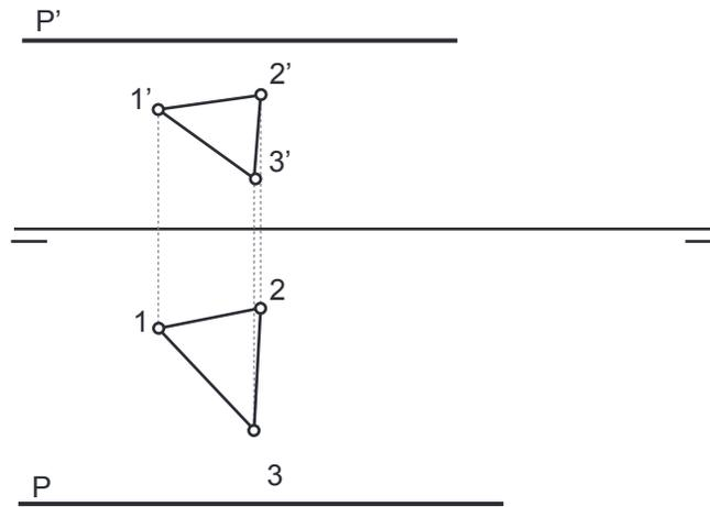
b) Dadas la traza vertical plano P, paralelo a LT, así como la representación del plano en tercera proyección y la proyección vertical y la tercera proyección de un cuadrilátero (1-2-3-4) contenido en él. Se pide la proyección horizontal del cuadrilátero, la traza horizontal del plano y la representación del cuadrilátero en verdadera magnitud y forma.
