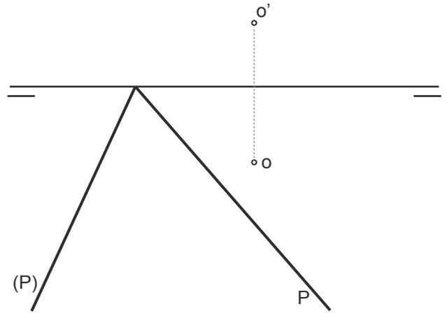
c) El segmento AB, contenido en el plano P, es el lado de un pentágono regular apoyado en el plano, el punto C es el vértice opuesto al lado AB del pentágono. Completa las proyecciones del pentágono. Para ello debes de abatir P sobre el PV.
