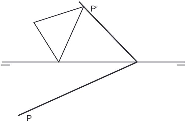
d) Dadas las trazas  $P$  y  $P'$  de un plano oblicuo y la proyección horizontal de un triángulo contenido en él, se pide que dibujes la proyección vertical del triángulo y su verdadera magnitud y forma.
