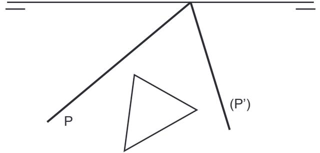
c) Dadas las trazas  $P$  y  $P'$  de un plano oblicuo y la proyección vertical de un triángulo contenido en él, se pide que dibujes la proyección horizontal del triángulo y su verdadera magnitud y forma.
